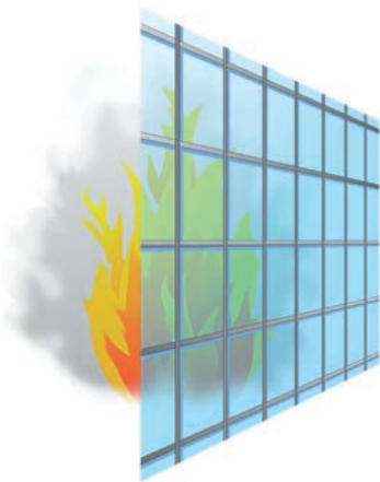
Brand från insida. Utfackningsvägg max höjd 3000 mm.
