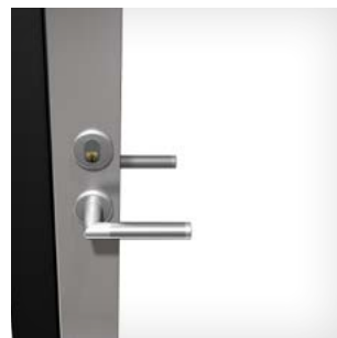
Trycke till inredörr. Trycke, vred, rosett och cylinderrosett med modulprofil. Bredd 137 mm, Ø 21 mm.
